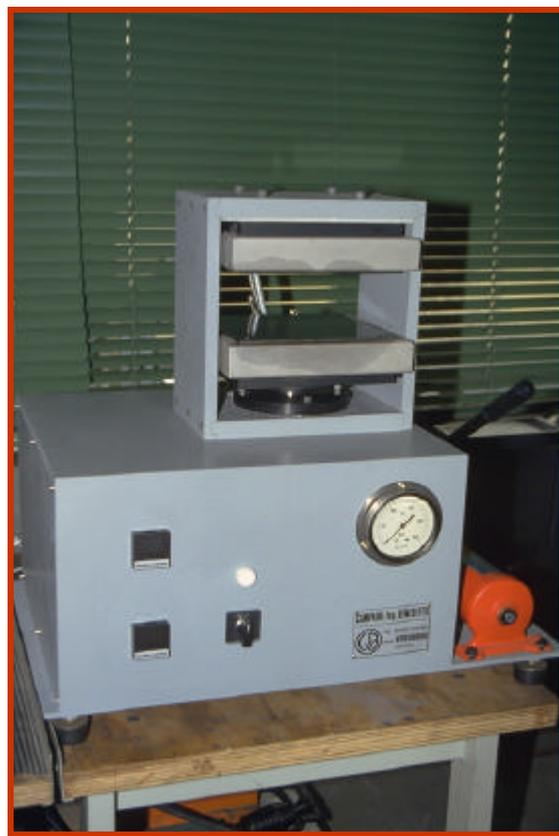
La Pressa **PM 20/200**, è idonea allo stampaggio di placchette di materiale plastico ed elastomerico, da cui ricavare i provini per le varie prove fisico-meccaniche.
